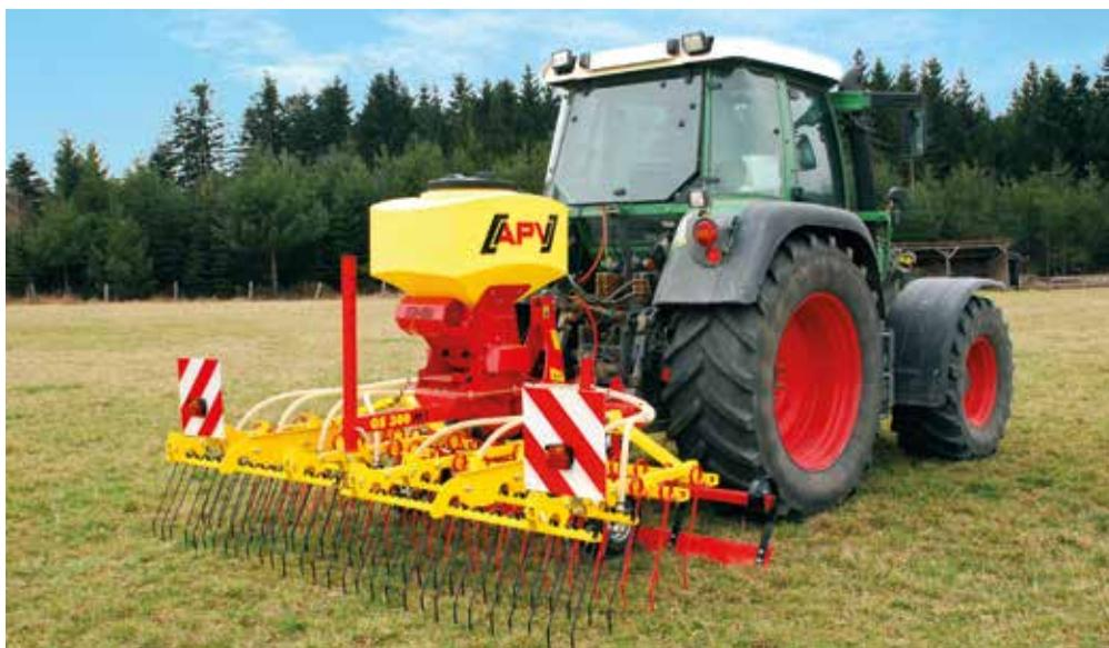
Grünlandstriegel in Kombination mit einem pneumatischen Sägerät von APV
