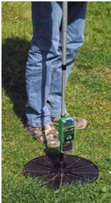
Dazu sind mehrere Messpunkte auf der gesamten Fläche aufzunehmen, entweder mit einem elektronischem Messgerät (s. Bild oben) oder mit einem Metermaß plus einem Plastikdeckel.
