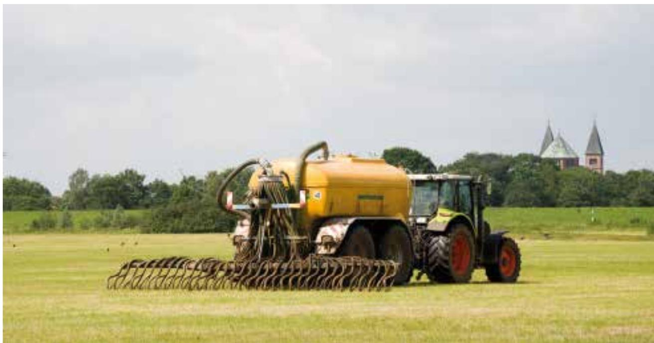
Ab 2025 muss auf Grünland (Ackerland 2020) Wirtschaftsdünger streifenförmiger ausgebracht oder direkt eingebracht werden. Neue Technologien, wie Schlitzverfahren, können helfen Stickstoffverluste zu minimieren.
