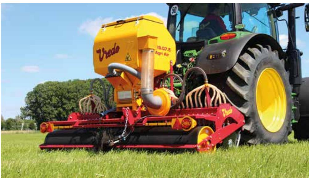
Pneumatische Durchsämmaschine mit Schlitztechnik von Vredo
